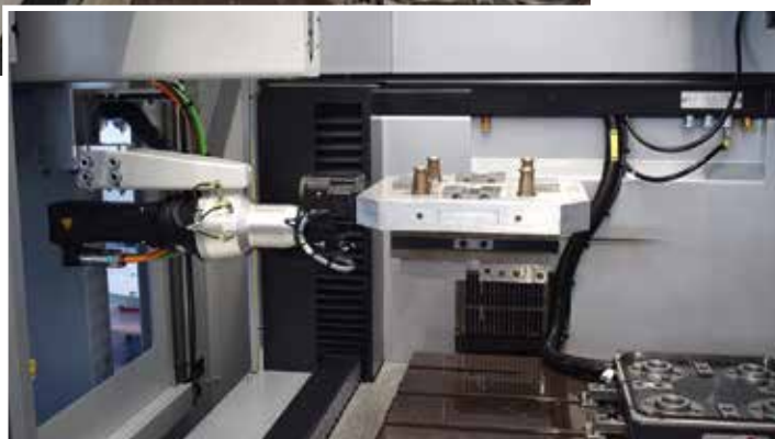
Erowa-Linear-roboter mit schneller SCR72P-Spindel und Schwenkachse: Nach dem Erodieren läuft das Dielektrikum von selbst ab
