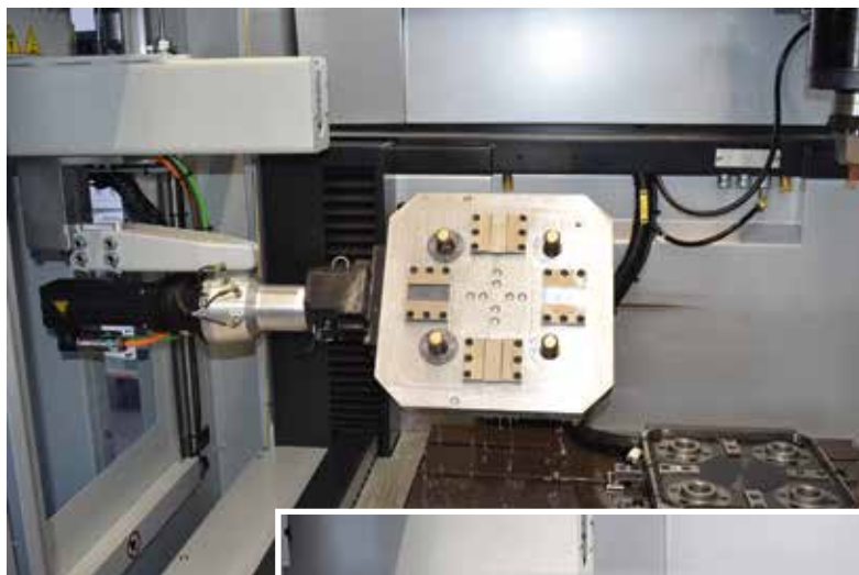
Erowa-Linear-roboter mit schneller SCR72P-Spindel und Schwenkachse: Nach dem Erodieren läuft das Dielektrikum von selbst ab
