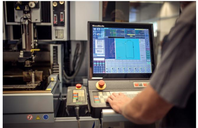
Bild 4+5: Neueste Generatortechnologie in Kombination mit innovativen Linearmotoren: Mit insgesamt 16 Premium-EDM gehört Gerhard Rauch zu den größten Sodick-Anwendern in Österreich und setzt 13 Draht- und 3 Senk-Erodiermaschinen ein. Senkerodiert wird ausschließlich am Standort Wien bei der Fertigung von Stanzwerkzeugen für die Dünnfolienherstellung
